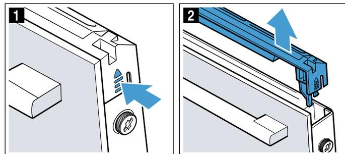
**Hinweis:** Den Edelstahlreinleger in der Abdeckung mit Edelstahlreiniger reinigen. Die restliche Türabdeckung mit Spüllauge und einem weichen Tuch reinigen.
